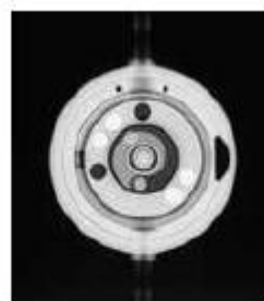
Fig. 6: imagem de raio X de uma unidade de pressão diferencial regulável, posição 14 cmH 2 O
