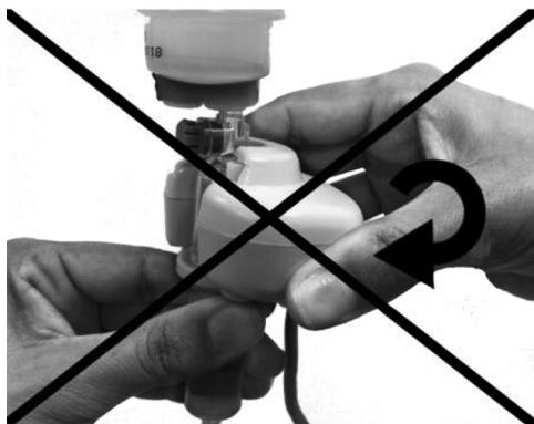
**Nunca tente retirar o sensor de gotas dual rotacionando-o. Sempre faça a colocação e remoção do mesmo de forma perpendicular à câmara de gotejamento.**
