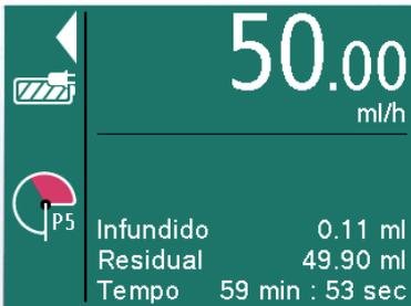
O nível de pressão definido é mostrado com um P (para pressão) e um número. Além disso, uma área vermelha mostra a rapidez com a qual será atingido o limite de alarme da pressão. O visor do "manômetro" mostra a pressão atual no sistema. Quanto menor for o nível do limite do alarme de pressão definido, quanto maior for a área vermelha,
