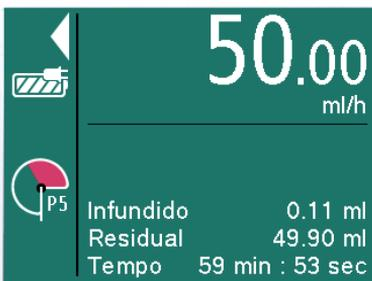
O nível de pressão definido é mostrado com um P (para pressão) e um número. Além disso, uma área vermelha mostra a rapidez com a qual será atingido o limite máximo de alarme. O visor do "manômetro" mostra a pressão
