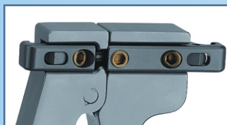
Imagem 22: Inserção do conector transversal no alicate de dobra FW203R
