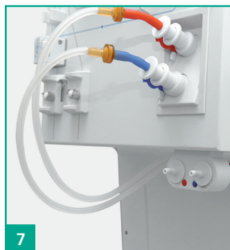
7 Conexão para Central de For- necimento de concentrados (Farmácia)
