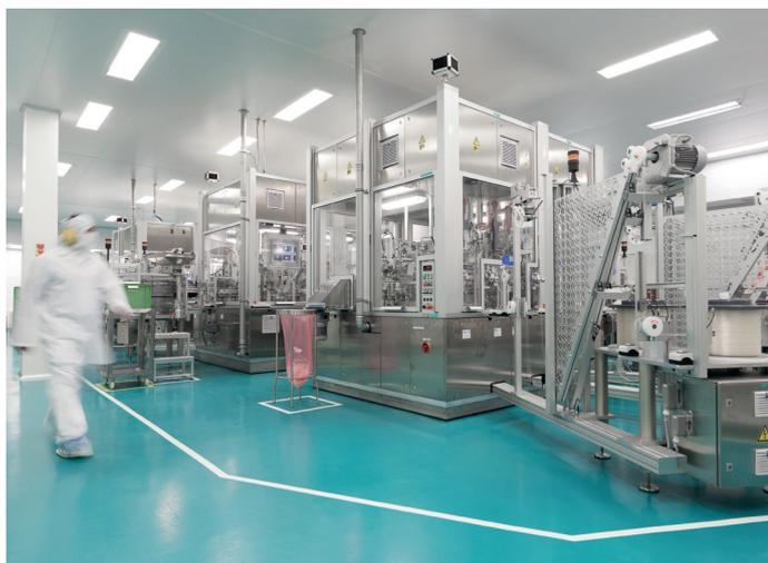
D.I.V.A (Double IV-Sets Assembly machine): automatização da montagem e embalagem de equipamentos
